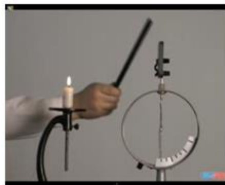
2.1-сүрөт. Металлды жарыктандырууда электрондордун бөлүнүп чыгышынын демонстрациясы.
